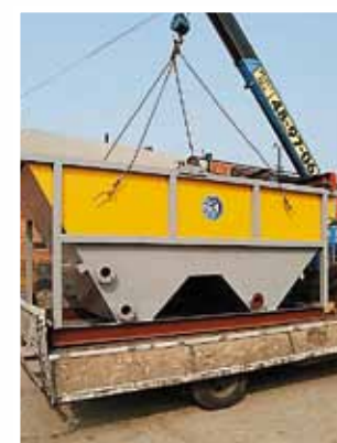
Тонкослойный отстойник - обеспечивает высокий процент очистки на первой ступени трехступенчатой схемы очистки
