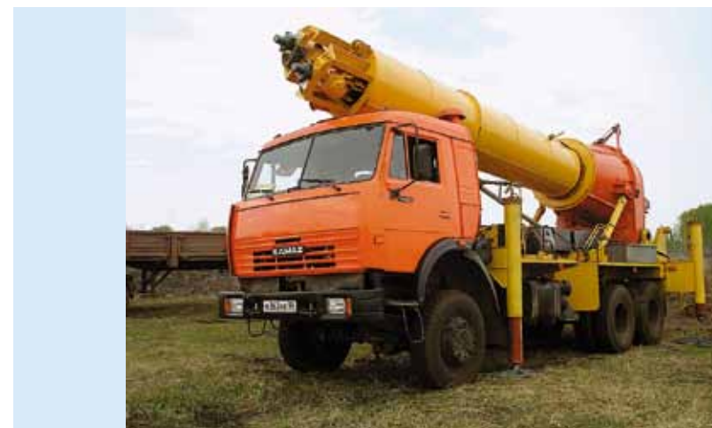
Машина закручивания свай МЗС-219 (производство ОАО КБТМ)
