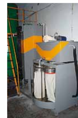
Устройство фильтрации и обезвоживания - предназначено для обезвоживания обводнённого осадка (содержание воды до 97-98%), избыточного активного ила, флотошлама или их смеси
