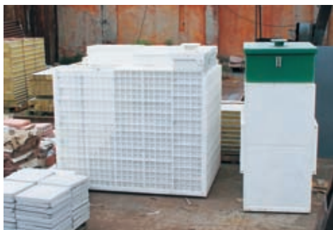
Станция биологической очистки перед монтажом
