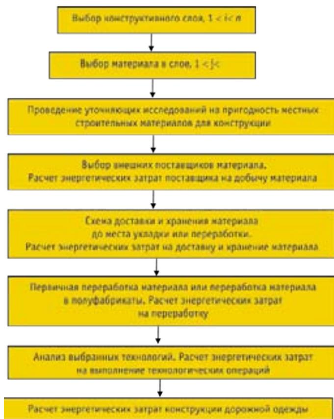
Рис. 1. Последовательность расчета энергетических затрат при строительстве конструкций дорожных одежд
